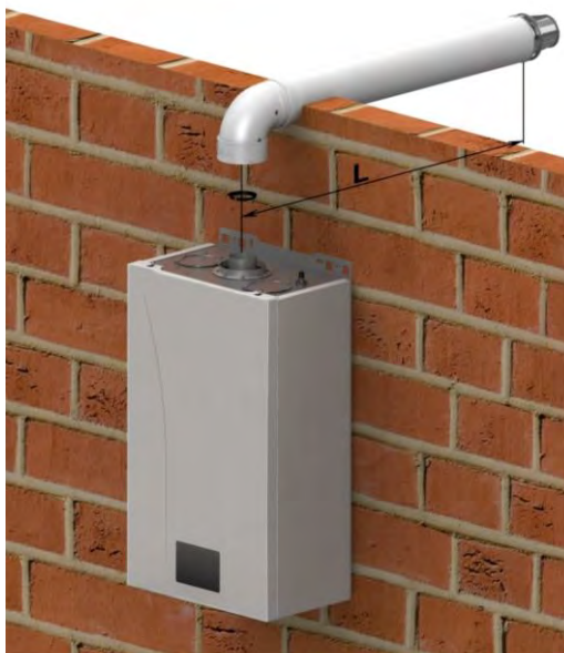
Рис. 4 Схема присоединения коаксиального дымохода Ø 100 / Ø 60 (мм) к котлу и установка диафрагмы
