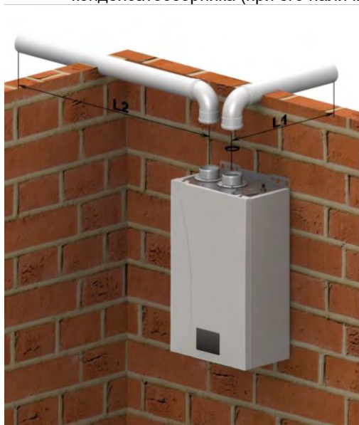
Рис. 5 Схемы присоединения отдельного дымохода Ø 80 мм к котлу и установка диафрагмы
