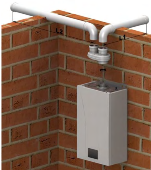
Рис. 5 Схемы присоединения отдельного дымохода Ø 80 мм к котлу и установка диафрагмы
