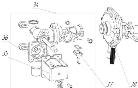
Рисунок 9. Узел водогазовый
