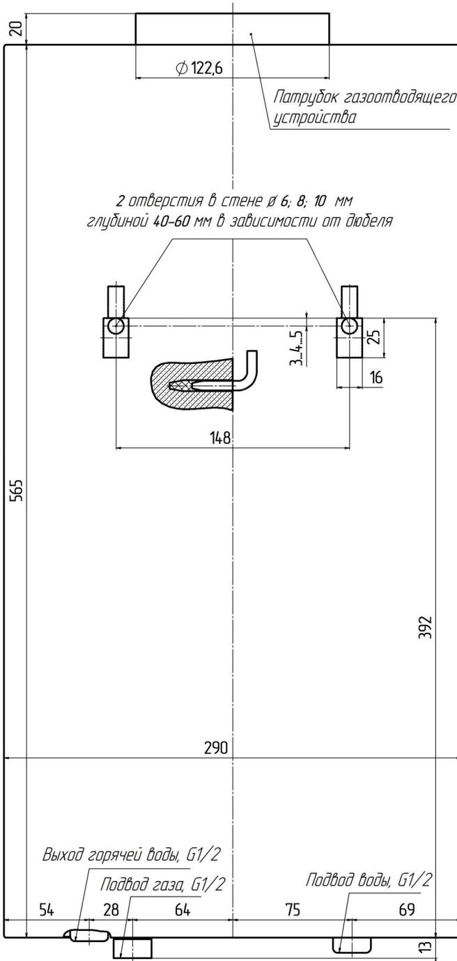
Рисунок 10. Схема крепления аппаратов ViTerm S10, ViTerm S11
