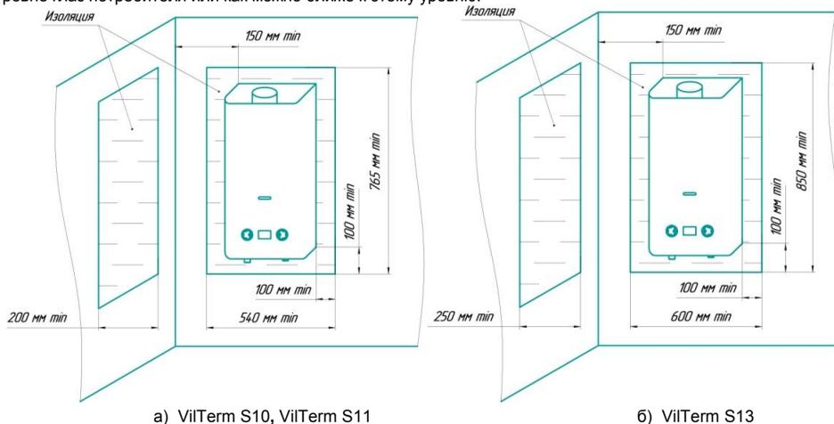
Рисунок 2. Пример установки аппаратов на трудногореаемых стенах
