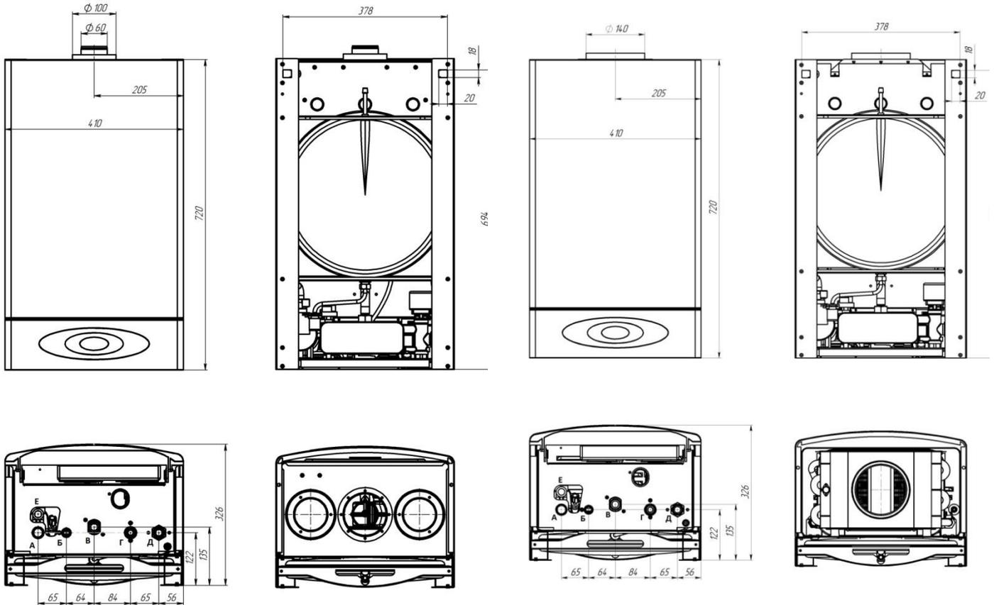
А – выход контура отопления G3/4;
