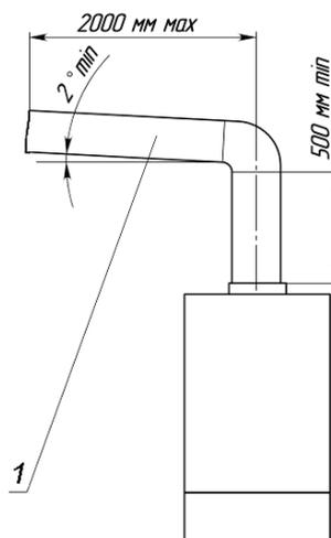
Рис. 11. Схема подсоединения дымоотводящей трубы для котла «ViTerm 24»
