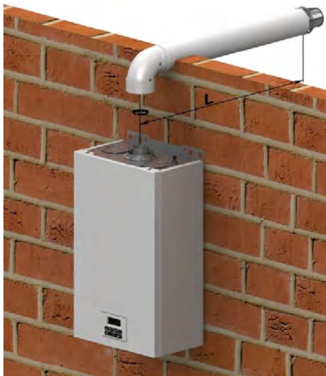
Рис. 4 Схема присоединения коаксиального дымохода \varnothing 100 / \varnothing 60 (мм) к аппарату и установка диафрагмы
