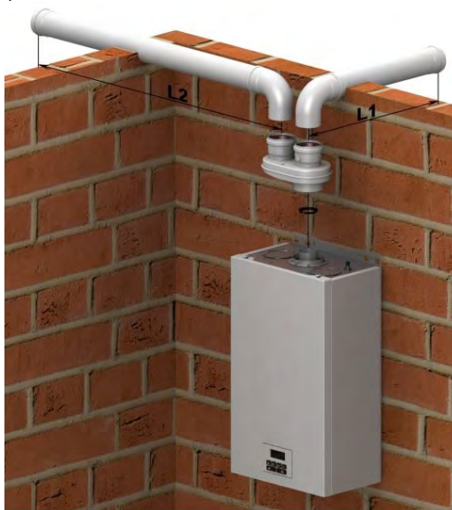
Рис. 5 Схемы присоединения отдельного дымохода \varnothing 80 мм к аппарату и установка диафрагмы
